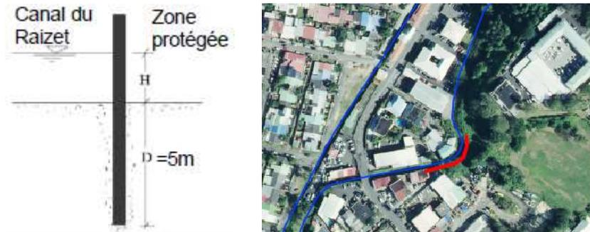
Figure 3 - Coupe type digue palplanche (à gauche) et localisation (en rouge à droite)
